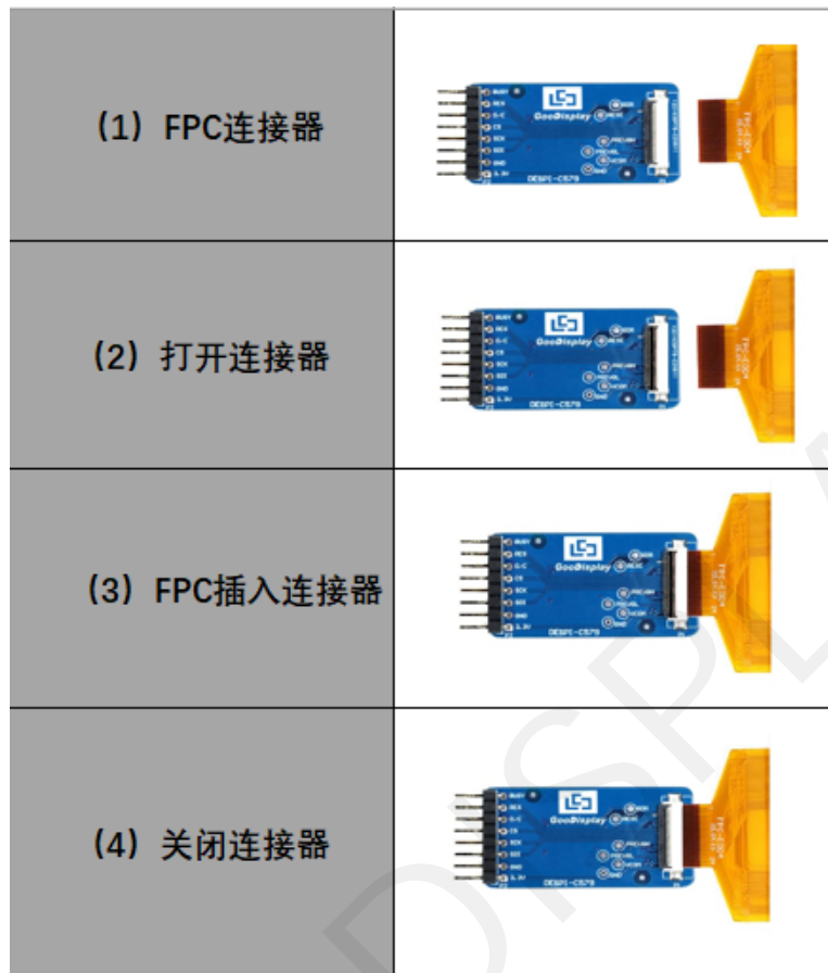
图4.2 电子纸显示屏与转接板连接步骤
