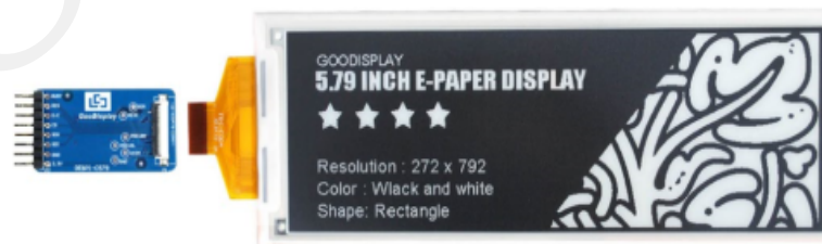
图4.1 电子纸显示屏与转接板插接示意图
